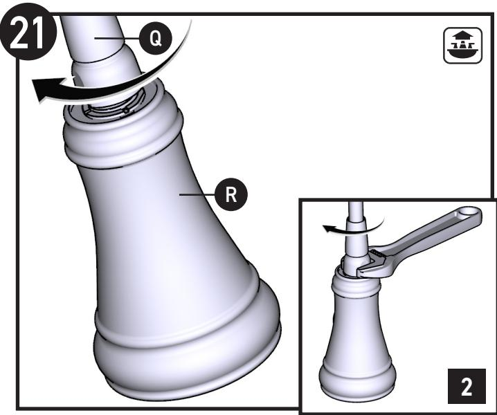
Retire la tapa de protección de la varilla del rociador (R) y deséchela. Instale la varilla del rociador (R) en la manguera retráctil (Q).
