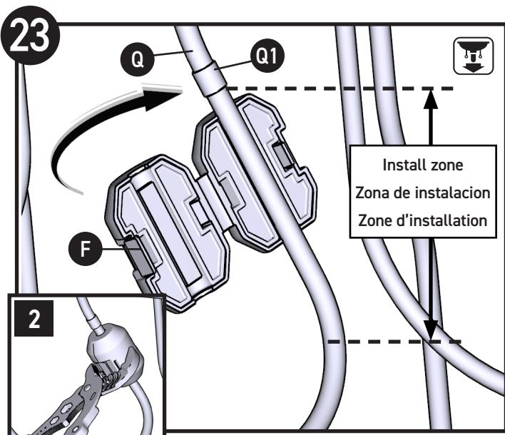
**IMPORTANTE:** Localice la marca de ubicación del peso de la manguera (Q1) en la manguera retráctil (Q). Instale el peso de la manguera (F) justo sobre el inicio de la curva de la manguera, del mismo lado donde se encuentra la marca de ubicación en el tubo. Los alicates ajustables pueden ser útiles para sujetar firmemente el peso de la manguera (F).
